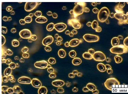
Рис. 4.15. Крахмал: a – структурная формула; б – частицы порошка; темнопольное освещение
