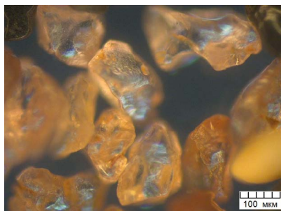
Рис. 4.8. Технический корунд (для гидроабразивной резки): a – съемка на отражение; б – съемка на просвет
