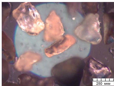
Рис. 4.8. Технический корунд (для гидроабразивной резки): a – съемка на отражение; б – съемка на просвет
